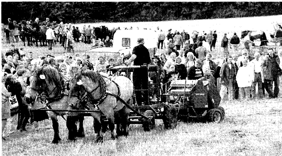
Auf der PferdeStark in Detmold war ein Vorderwagen vor einer Mini-Rundballenpresse im Einsatz zu sehen und zog dabei sehr viel Aufmerksamkeit auf sich. Das „Pintow Power Cart“ für Grünland der britischen Firma Carthorsemachinery verfügt über eine Dreipunkt-Hydraulik und eine über die Räder angetriebene Zapfwelle, mit deren Hilfe Anbaugeräte wie Doppelmesser-Mähwerk, Heuwender oder Kreiselchwader betrieben werden können. Mit Hilfe eines Aufbaumotors können nahezu alle auf einem Betrieb anfallenden Arbeiten mit einem Gerät effizient und energiesparend durchgeführt werden.
