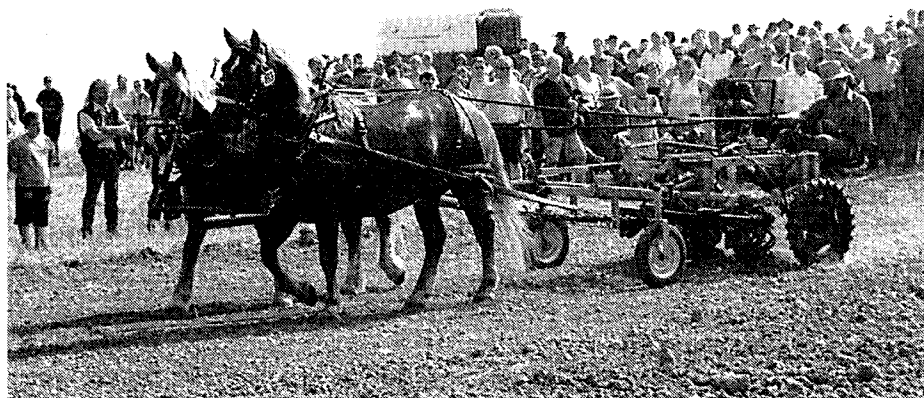
Der bereits 2001 preisgekrönte „Univecus“ des Demeter-Bauern Hannsjörg Fischer konnte bei der praktischen Arbeit begutachtet werden. Dieser Geräteträger ermöglicht im Zwischenachsenaufbau die Verwendung des ursprünglich für den Fendt-Geräteträger konzipierten Arbeitsbalkens. Mittels Schnellverschluss kann dieser mit den vormontierten Hacken, Häufelkörpern oder Sämaschinen ausgestattet werden. Mit einer Spurbreite von 125 bis 175 cm ist es ein ideales Gerät für alle Reihenkulturen und wird mittlerweile von der Schweizer Firma Burkhalter in Lizenz gebaut und vertrieben. Fotos: Fulde
