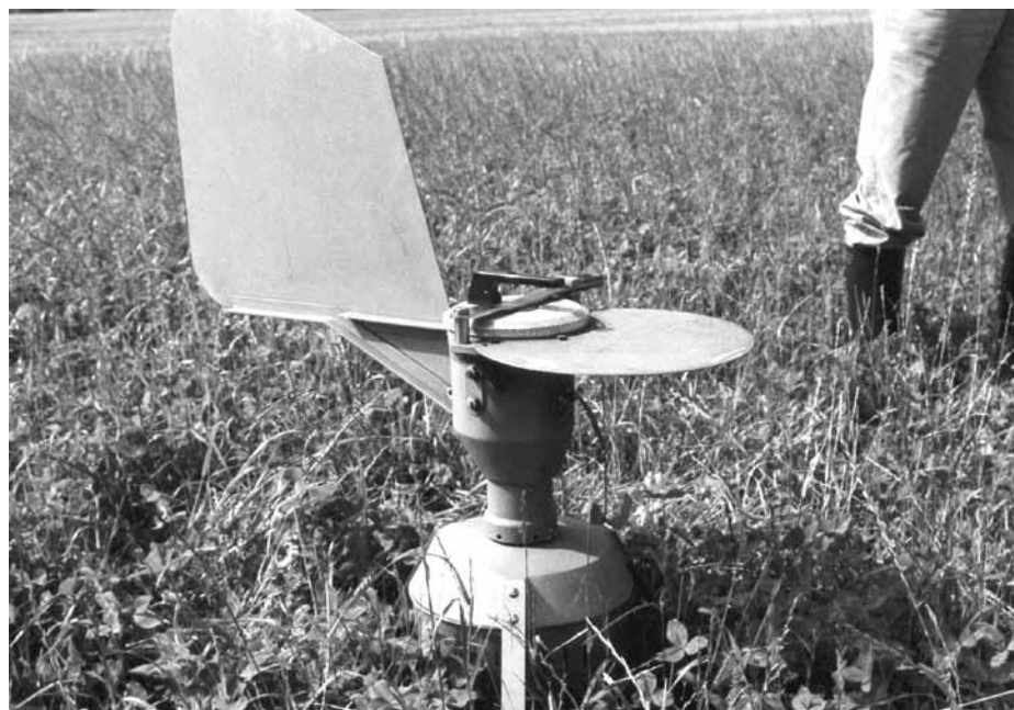
Pollenfallen zur Untersuchung der Ausbreitungsentfernung gentechnisch veränderter Pollen. Bei Neuzulassungen wird gerne auf bestehende Daten zurückgegriffen. Foto: www.biosicherheit.de
