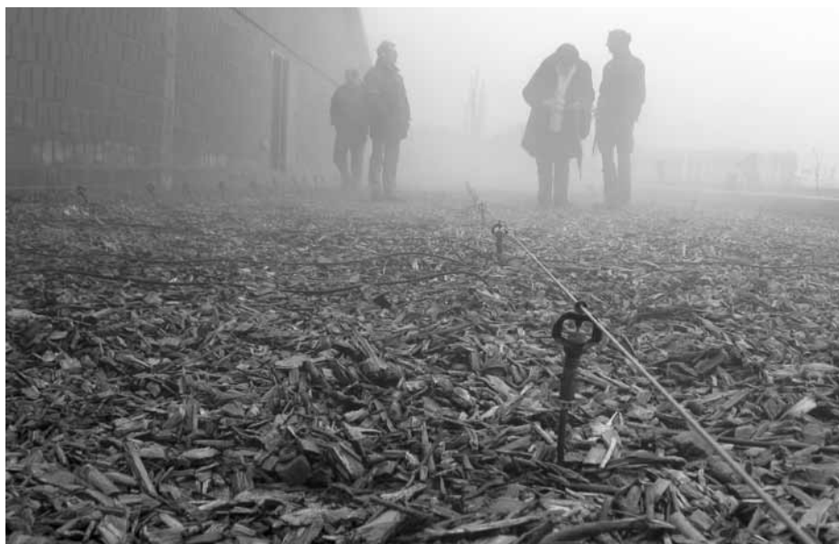
Hackschnitzel als Träger für ammoniakbindende Bakterien. Ein Biofilter für kleine Ställe. Foto: Niemann
