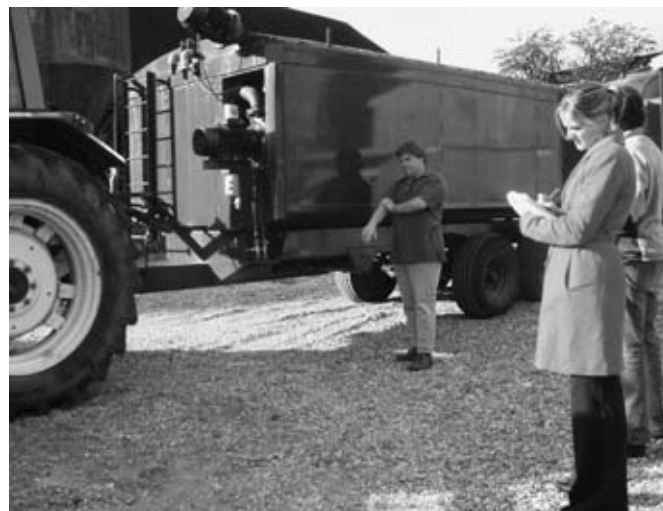
Mit seinem „Portagester“, einem 10 m 3 großen Tank auf Rädern als mobilem Trockenfermentations-Fermenter, betreibt Farmer Chris Reynell die wohl kleinste Biogasanlage Englands. Foto: IBBK
